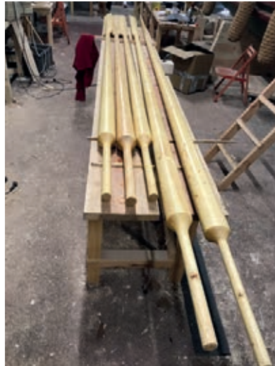
▲ Blick in die Werkstatt: Riemen verschiedener Länge (410, 440, 470 cm) wurden für die F.A.N. hergestellt.
