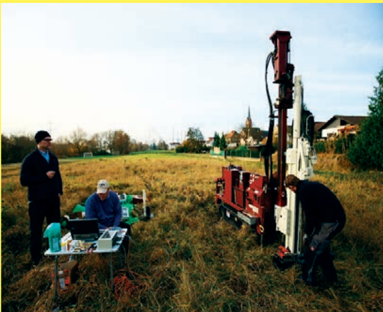
▲ Ein Raupenfahrzeug mit Bohreinrichtung für das DP EC-Verfahren. Im Bildhintergrund die untersuchte Arbeitsfläche im Vorfeld des ehemaligen römischen Kastells (im Bereich des Kirchturms).
