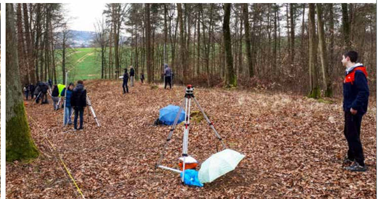
▲ Klasse 8 beim Vermessen der Limesprofile. In der linken Bildhälfte ist die Hauptmesslinie erkennbar.
