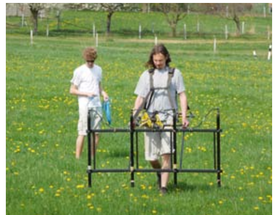
Geomagnetische Prospektion an der Limesstrecke 2 bei Berg. Das Wiesengelände wird mit dem Messgerät, einem Fluxgate-Gradiometer, in einem Raster von 0,2 m × 0,5 m systematisch begangen.
