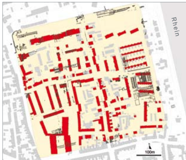
Bodeneingriffskartierung. Für jede Baumaßnahme wurde anhand der Bauakten der Bodeneingriff, meist sind es Kellerbauten, im GIS erfasst. Die Eingriffstiefen lassen sich filtern und in verschiedenen Größenbereichen darstellen. Hier die Eingriffe, die die archäologische Substanz zerstört haben.
