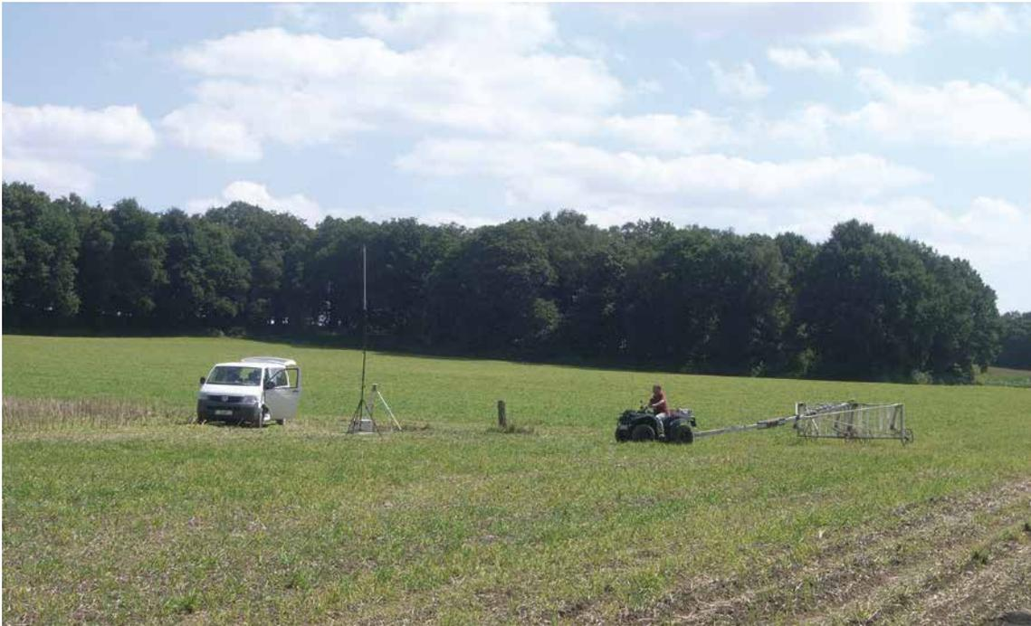
Das 16-Kanal-Magnetometersystem der Firma Sensys mit GPS-Station im Einsatz.
